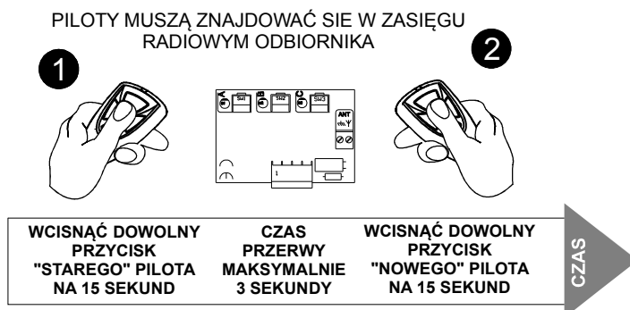
Rysunek 6. Zdalne dopisywanie pilota.
